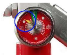
เครื่องดับเพลิง สภาพขัดข้อง (เข็มชี้ช่องแดง)
